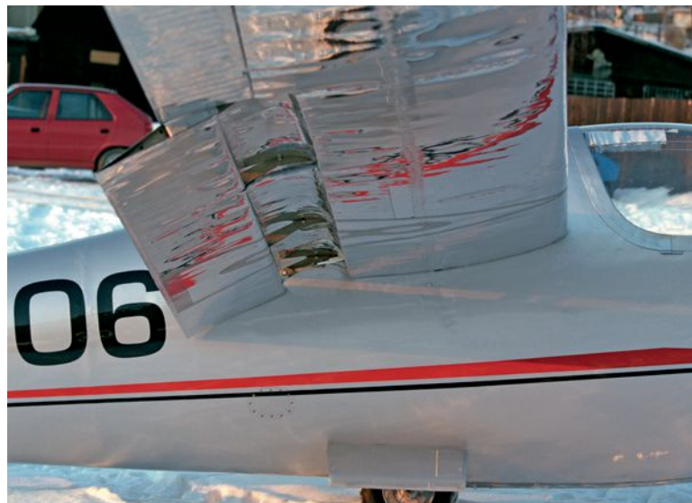
Die Fowler-Klappen werden je nach Steigen mehr oder weniger gesetzt
